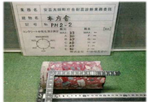
コンクリート中性化深度測定
